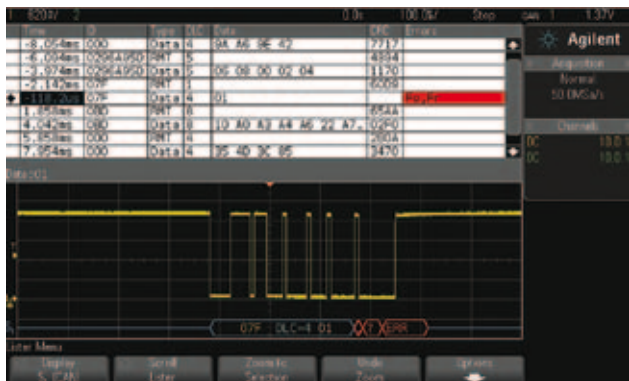
图1: 硬件解码可以快速发现串行通信错误。
