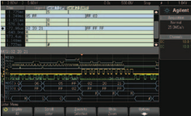
图3: 交叉“列表”可以更方便地实现2个解码串行总线之间的时间关联。
