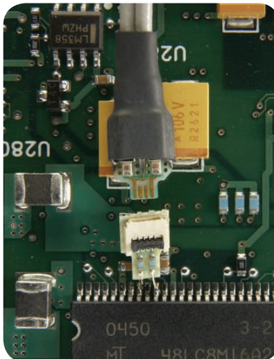
InfiniiMax ZIF tip soldered on board
