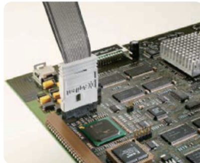
E5346A 34 通道 Mictor 连接器探头
