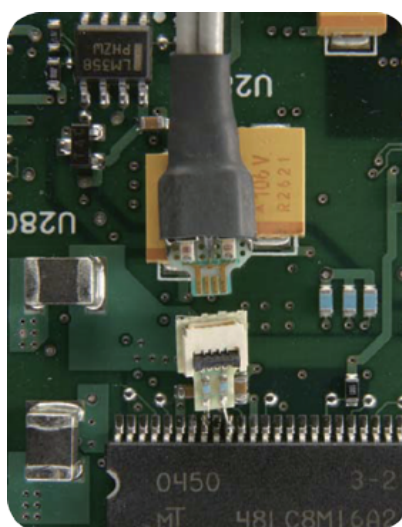
电路板上的 InfiniiMax ZIF 焊接探针
