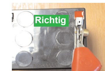
Klemmen Sie enganliegend an die Flachstecker
