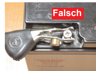
Niemals an hochhohmige Schrauben anklammern
