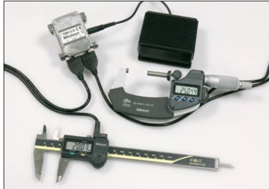
Anwendungsbeispiel mit Fußschalter (Sonderzubehör)
