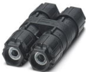
H型分配器，QUICKON速连，位数: 3+PE，1 mm 2 ... 2.5 mm 2 ，690 V，20 A，黑色，带四个QUICKON螺母，电缆直径范围: 9 mm ... 14 mm
