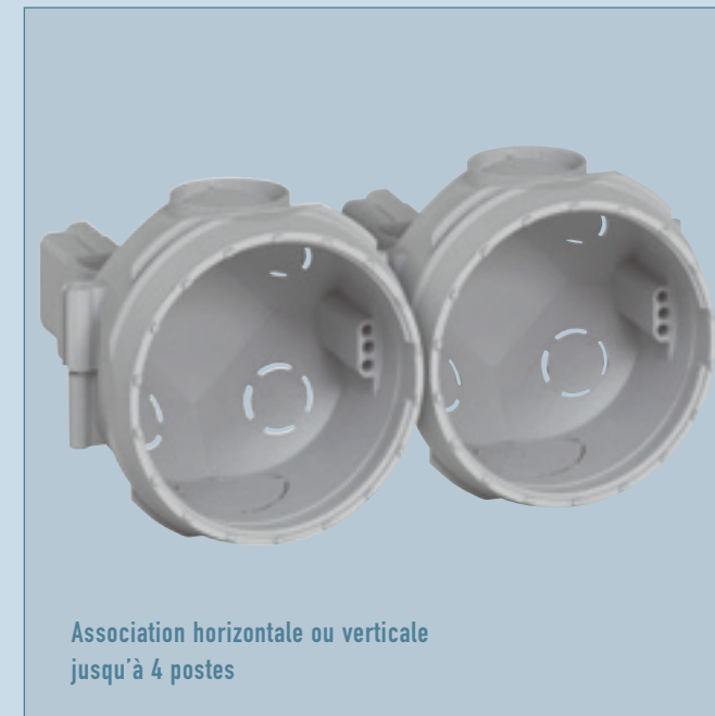
Jumelage par clipsage direct pour banche afin d'assurer le calage ou le montage dos à dos (ép. 140, 160, 180, 200 mm)
