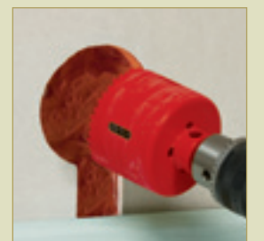
Perçage à la scie cloche Ø67 mm
