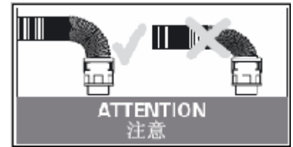
If bending the conduit, 如果软管需弯曲, 则请保 please keep to the 持在软管的推荐弯曲半径 recommended bending radius. 范围内。
