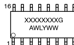
SOIC-16 D SUFFIX CASE 751B
