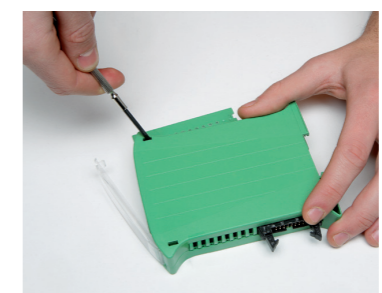
Sgancio del coperchio dalla base. Unhooking the cover from the base.
