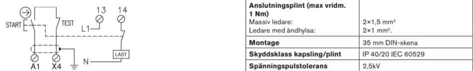
Kontrollera att ON-knappen inte fastnar i intryckt läge. Kortslutning över slutande kontakt övervakas ej.
