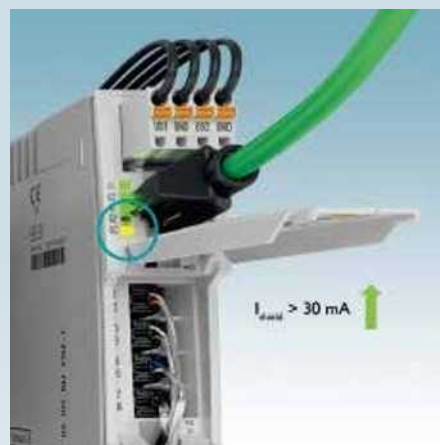
实时检测以太网电缆屏蔽层中干扰电流并具备报警显示功能
