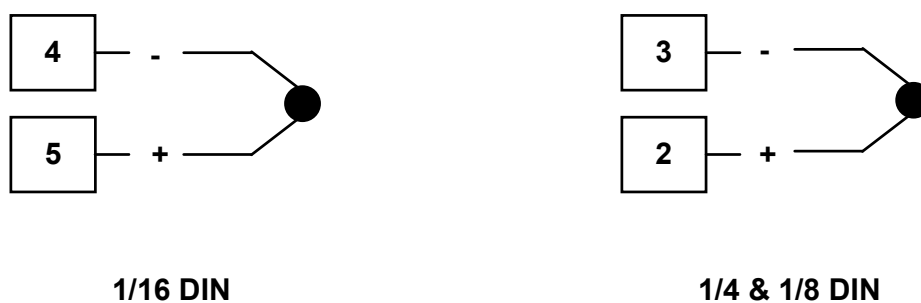
Bild 13 - Anschluss Universal – Eingang: Thermoelement
