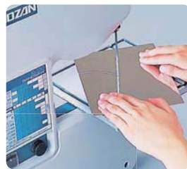
アルミ板の曲線切り作業
