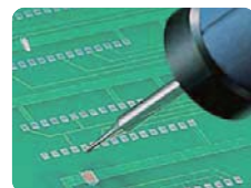
レジスト被膜のはく離
