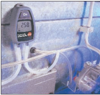
Messung des Kaminzugs, Überwachung von Filtern und Überprüfung von Ventilatoren
