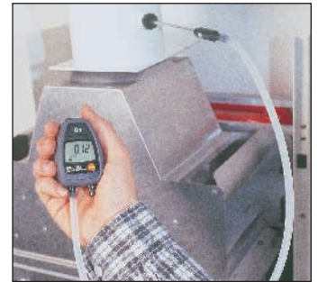
Umschaltbarer Messbereich; Gasfließdruck und Kaminzugmessung
