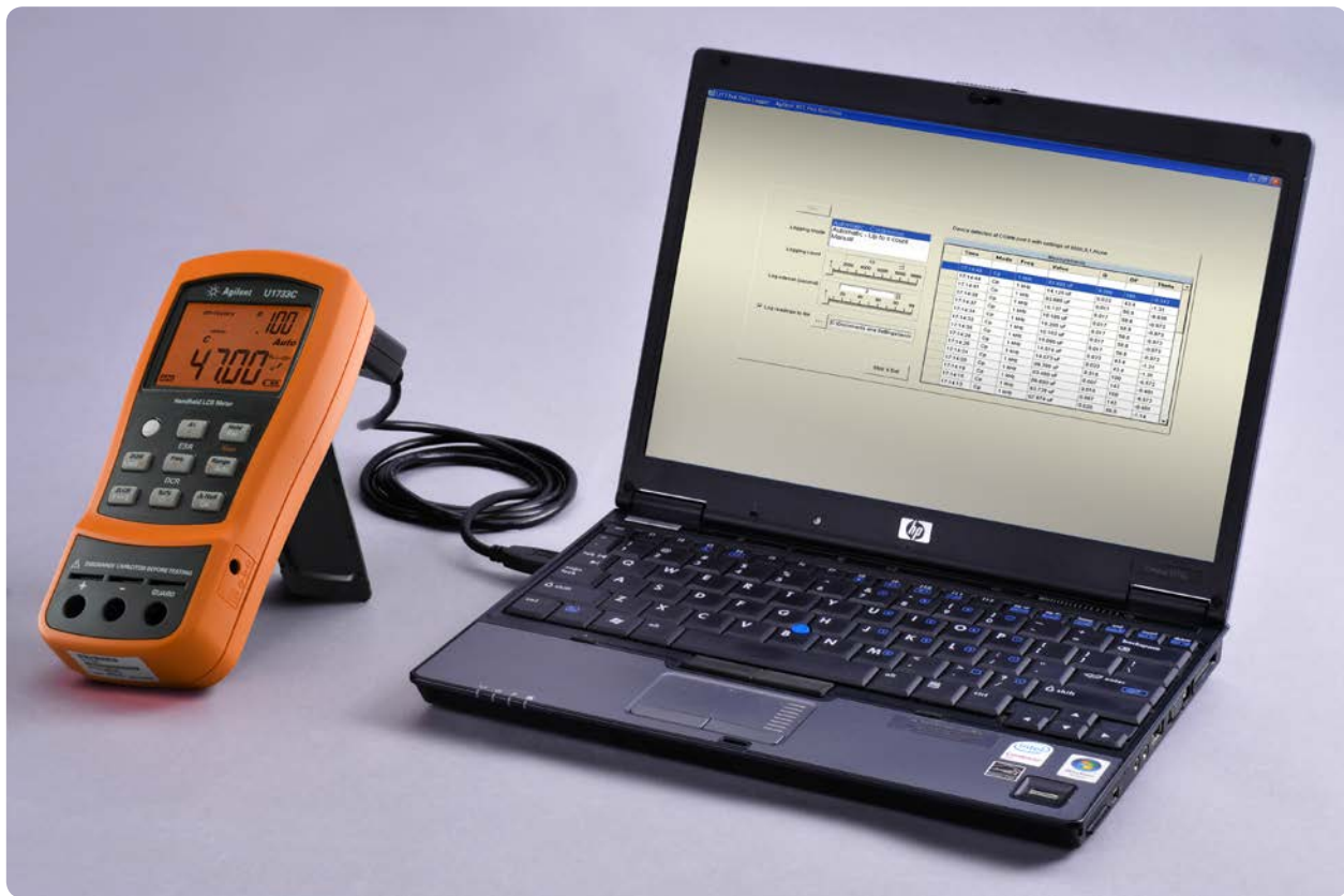
圖1：將Agilent U1731C/U1732C/U1733C連接到PC，便可自動且連續地記錄讀值
