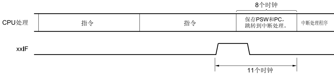
图 11-8. 中断请求受理时序 (最短时间)
