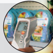
2-Punkt-Lasermarkierung (realer Messfleck)
